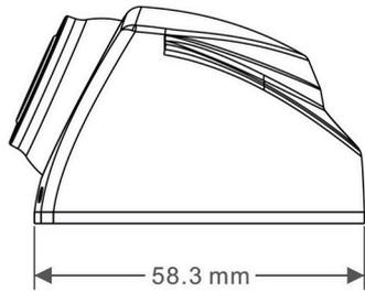
Die Kamera wird direkt über das Monitorkabel verbunden und benötigt keine eigene Stromversorgung.
